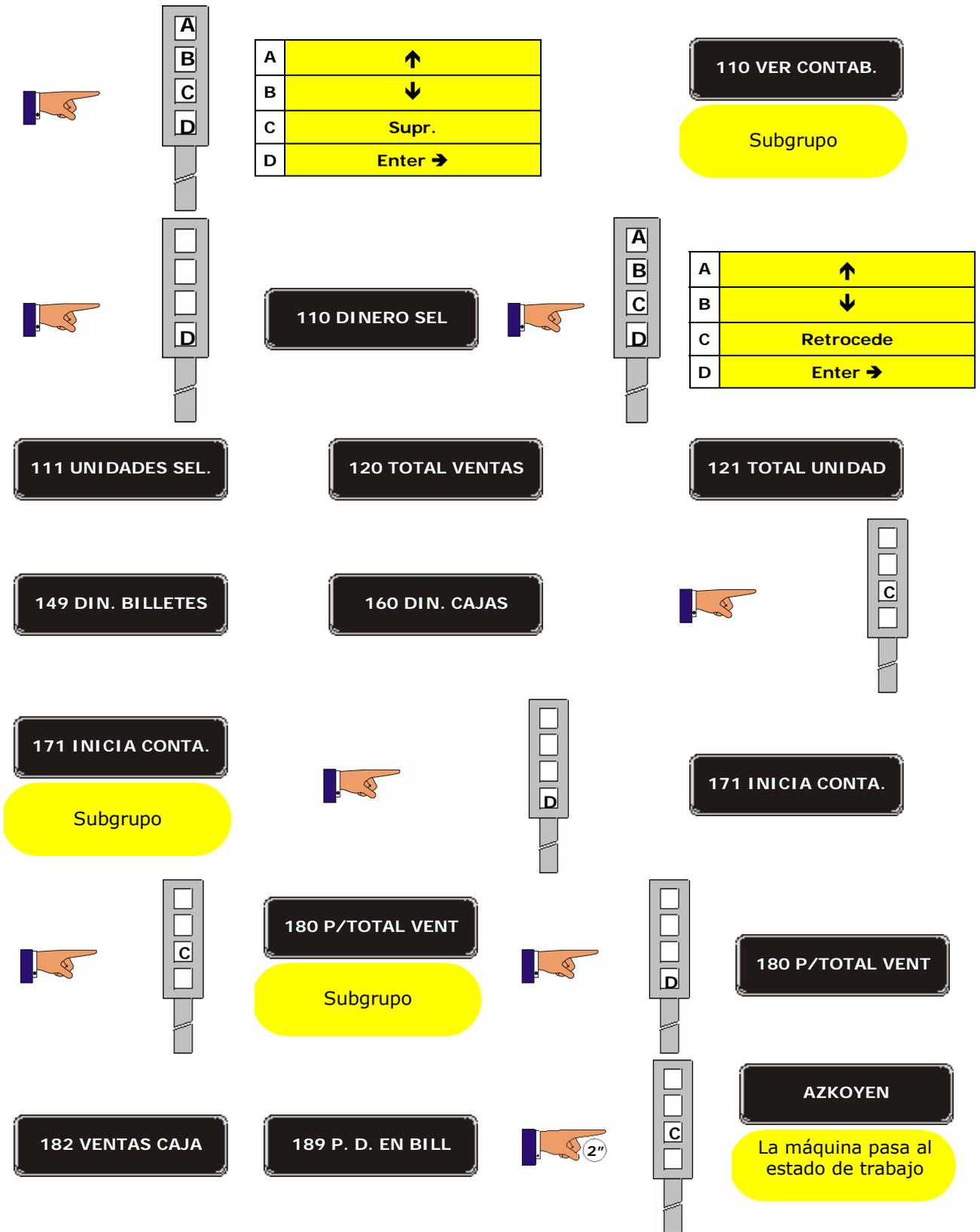
En los casos en los que se utilice un teclado de 60 teclas existe otro método para extraer las contabilidades de la máquina:
