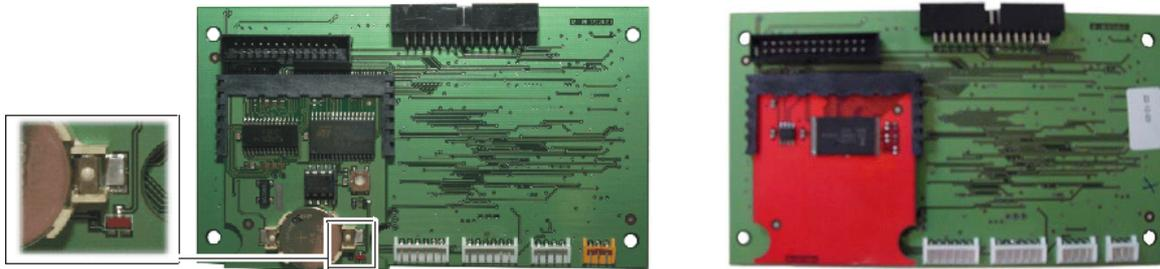
Tarjeta de control con la memoria RAM y vista del diodo led
