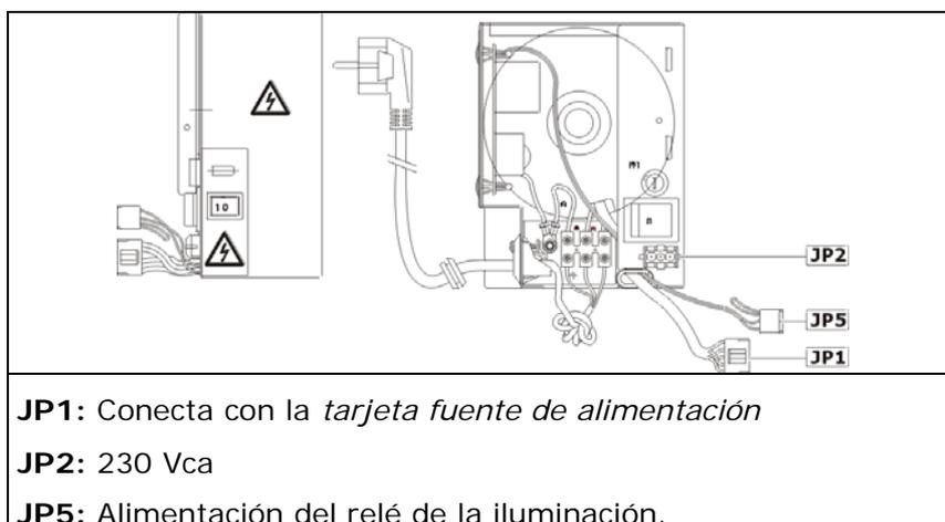
El *transformador* es del tipo toroidal con una potencia de 80 w. Cuenta con un *filtro* de red contra parásitos, un *varistor* y un *fusible* de 1 A. El *interruptor* de la red eléctrica está dotado de iluminación y corta los dos polos eléctricos de 230 Vca.
