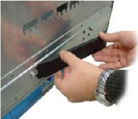
Para finalizar el montaje del canal se coloca si corresponde el separador lateral sólo si se indica en la tabla correspondiente teniendo en cuenta que existen dos tipos; de 4 y de 8 mm.
