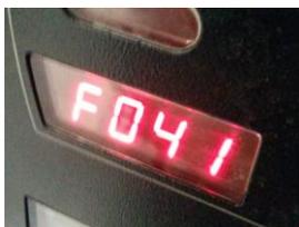
5.2. Seleccione el canal a inicializar apretando una vez manualmente la chapa que acciona el micro-switch de agotado producto. Puede dejar de apretar una vez vea EEEE en el display, esto significa que el canal está seleccionado.
