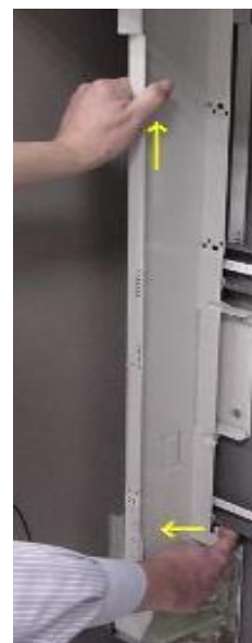
Forzar hacia afuera la patilla del canal y tirar de él hacia arriba.
