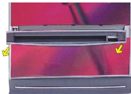
**Seguidamente extraer la boca de salida por la parte frontal de la máquina**
