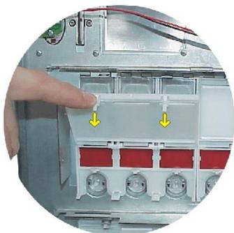
Abatir el soporte de marcas situado en la parte posterior del panel de selección presionando las patillas indicadas en la figura lateral.
