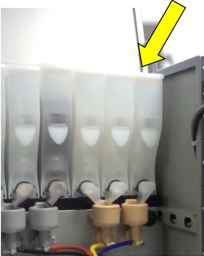
Abra la puerta de la máquina y levante la tapa superior de la máquina para acceder a la carga de las tolvas. Levante la tapa de la tolva a cargar e introduzca el producto. Tenga cuidado de que el producto cargado corresponde al que tenía la tolva (cada tolva posee una etiqueta que indica el producto a cargar).
