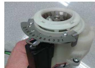
**Siempre que se realiza un ajuste se debe comprobar que la dosis es la deseada y se deben realizar unos servicios de café para comprobar el funcionamiento correcto.**
